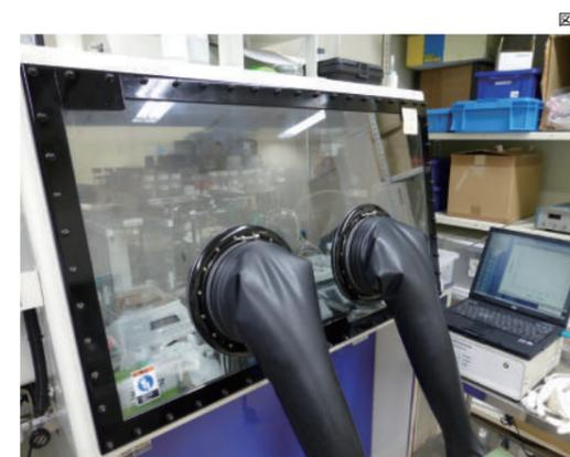
図5 電池をイオン液体の研究に使用するグローブボックス装置。内部は水分および酸素がいずれも 1ppm 以下のアルゴン雰囲気には保たれている。
