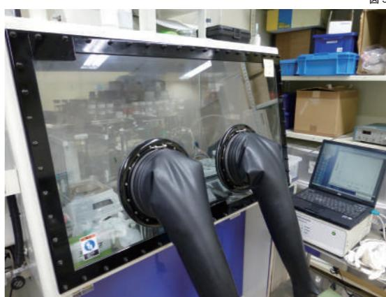
図5 電池をやイオン液体の研究に使用するグローブボックス装置。内部は水分および酸素がいずれも1ppm以下のアルゴン雰囲気で保たれている。
