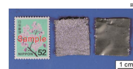
図4 溶融塩中での電気分解によってMo基板上に析出させた後、基板から分離して得られたTi箔。
