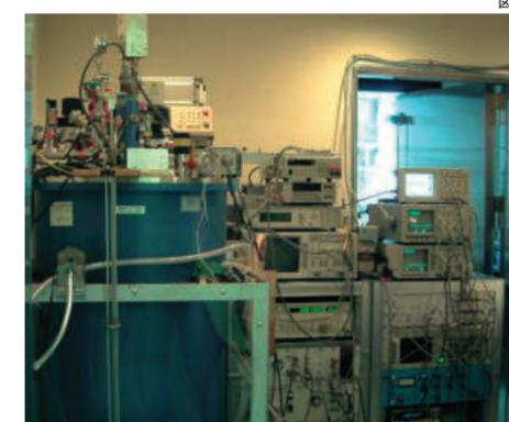
写真4 超伝導マグネットと固体の磁性を測定するためのNMR装置
