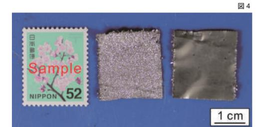
図4 溶融塩中での電気分解によってMo基板上に析出させた後、基板から分離して得られたTi箔。
