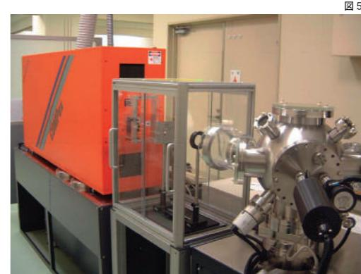
図5 パルスレーザー堆積装置
